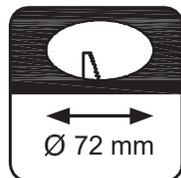
Prevedere e verificare il corretto dimensionamento del foro e degli spazi di montaggio
