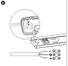
Effettuare i collegamenti elettrici, avendo cura di effettuare anche il collegamento di terra in maniera stabile.
