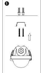
Fissare sulla parete di posa le 2 staffe di fissaggio, rispettando le distanze L1 previste per i vari modelli.
